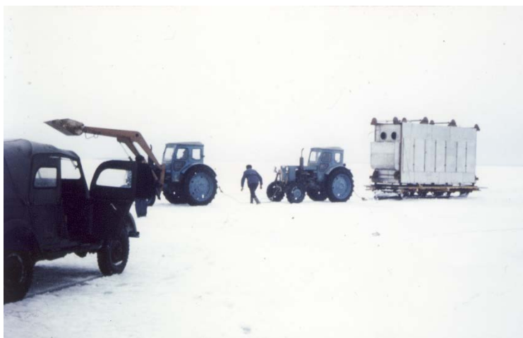
Kaks traktorit T-40, blansheerimisagregaat ja veokek võisid ühtekokku kaaluda 18-20 tonni. Jää paksus oli ca 21-23 cm...
